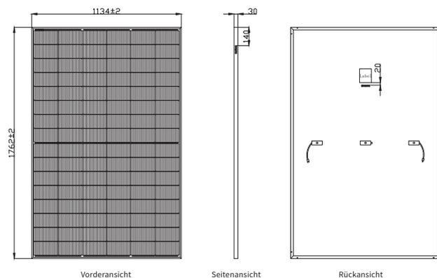
\* Die nicht gekennzeichnete Toleranz beträgt ±1 mm Länge in mm angegeben
